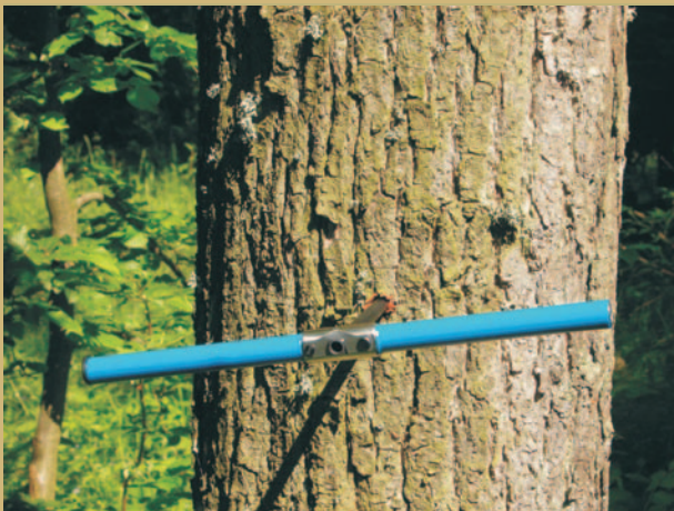
Ryc. 2. Analizę przyrostów pierśnicy dębów przeprowadzono na wywiertach wykonanych świdrem Presslera.
