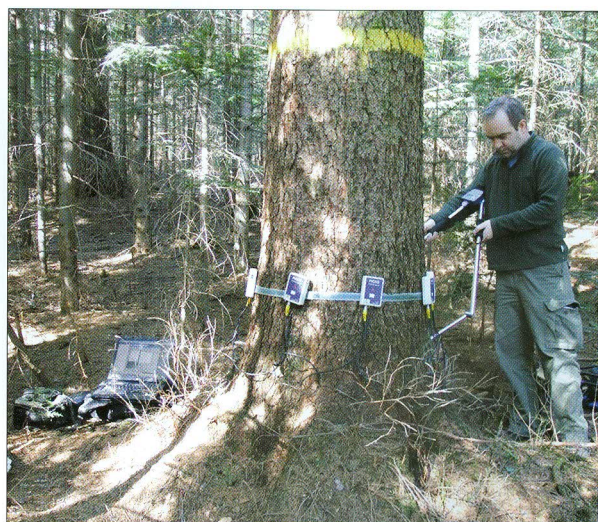
Mgr inż. Mariusz Kapsa podczas analizy drzewa matecznego tomografem akustycznym Picus Sonic fot. S. Ambroży
