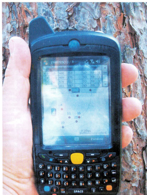
Rys. 5. Podczas prac terenowych wyniki pomiarów wprowadza się do rejestratorów i tableatów, wyposażonych w odbiornik GPS oraz zapisaną w pamięci mapę tematyczną.
