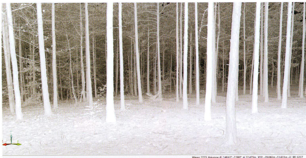
Rys. 1. i rys. 4. Wizualizacja chmury punktów ze skanowania laserem naziemnym. Skanowanie takie umożliwia precyzyjne pomiary drzew na dowolnej wysokości oraz tworzenie przestrzennych modeli drzewostanów.
