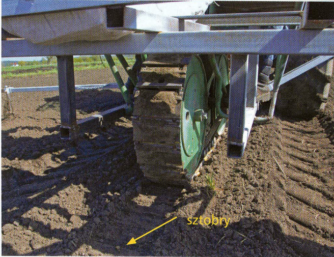
Technologia zakładania topolowej plantacji energetycznej ze sztobrów z zastosowaniem sadzarki gąsienicowej
