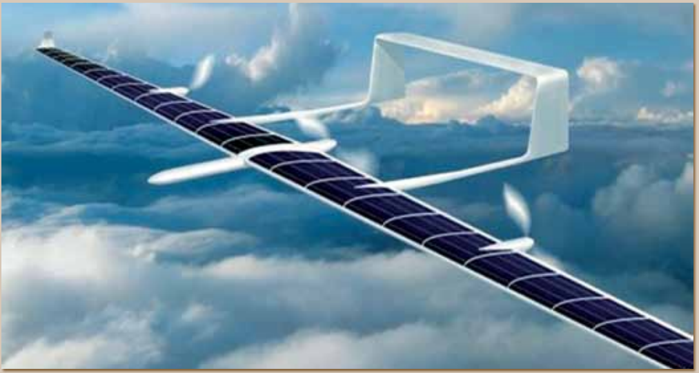
Ryc. 1. Bezałogowy Statek Powietrzny (BSP) wykorzystuje energię słoneczną, dzięki czemu może latać praktycznie bez przerwy.
