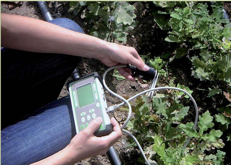
Ryc. 1. Pomiar fluorescencji chlorofilu a za pomocą fluorymetru HandyPEA (Firma Hansatech Instruments Ltd., Anglia)
