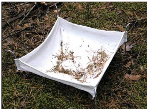
Tacka opadowa o powierzchni chwytnej około 0,1 m 2 (fot. L. Sukovata)
