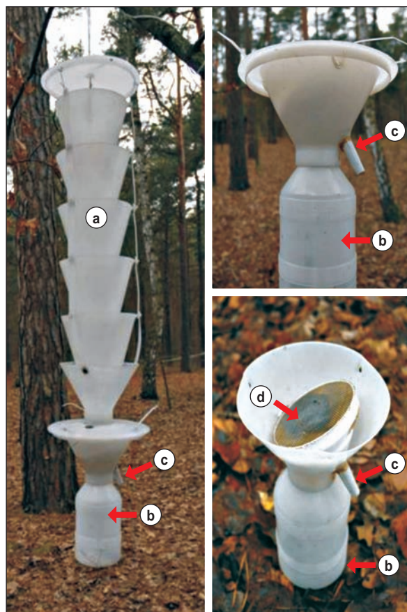
Pułapka IBL-3 wyposażona w zmodyfikowany system odprowadzania wody opadowej według pomysłu L. Cwiklińskiego. Na zdjęciu zaznaczono: a) korpus pułapki; b) pojemnik z płynem konserwującym; c) odprowadzenie wody; d) siatka wlotu do odprowadzania wody
