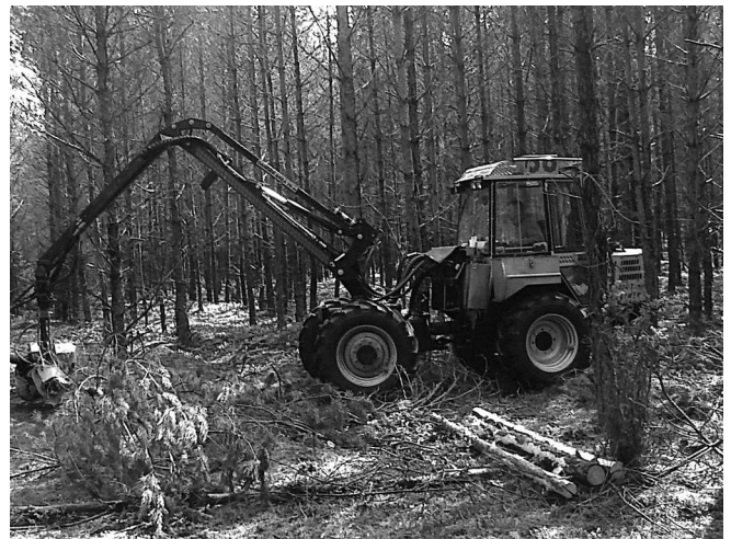
Rycina 2. Harvester Vimek 404 T5 podczas wyrabiania sortymentów
