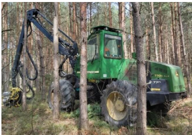
Rycina 2. Harwester John Deere 770 z głowicą H412 na szlaku operacyjnym w wariantcie H [fot. B. Brzoza]
