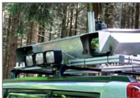
Rycina 5. Urządzenie fotooptyczne zamontowane na dachu samochodu terenowego. Obok przykład wydruku wyników pomiaru (fot. K.Jodłowski)
