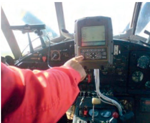
Fotografia 4. System nawigacji satelitarnej montowany w samolotach i helikopterach wykorzystywanych do zwalczania szkodliwych owadów leśnych
