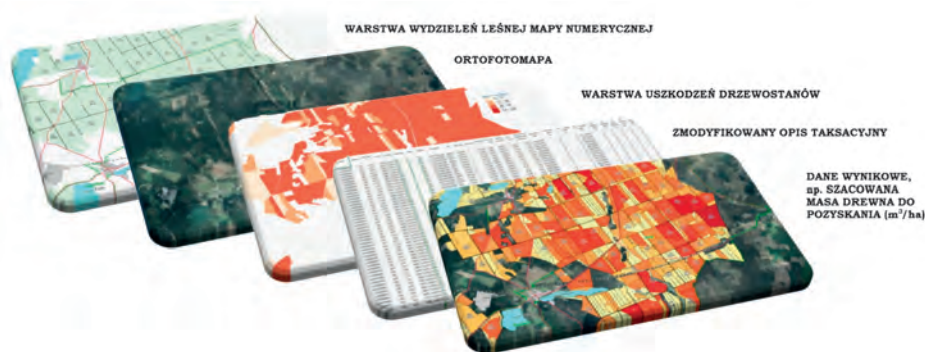
Rycina 7. Schemat postępowania przy szacowaniu szkód po huraganie w 2017 r. w RDLP w Szczecinku (źródło: Ramion-Harkawik A.)
