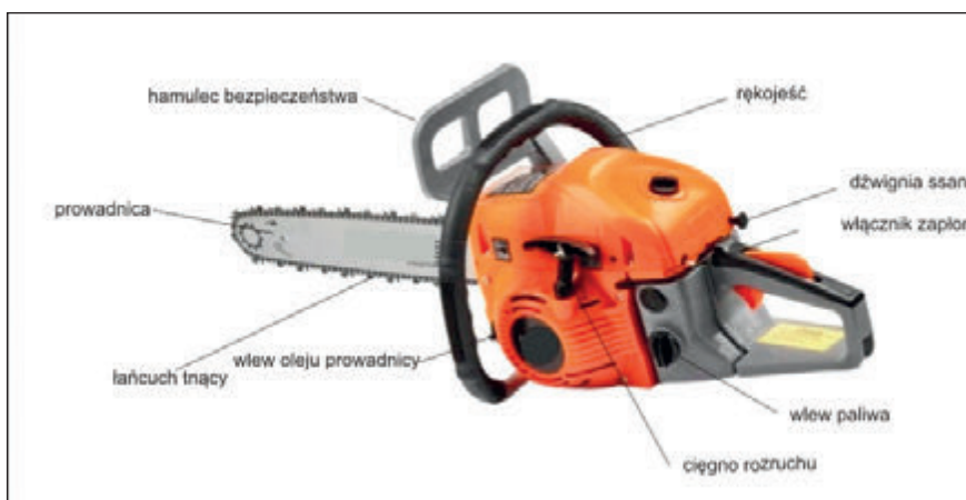
Ryc. 1. Schemat pilarki spalinowej (rys. W. Janiszewski)
